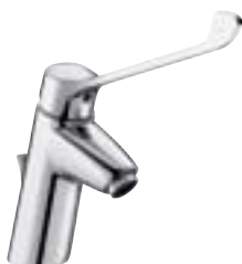
E18161 Monomando lavabo Panache Easy con palanca de 150 mm. Vaciador automático, cartucho secuencial pre-regulado a 40° C de temperatura.
