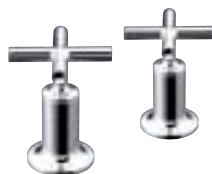
E144293 Mezclador bañera. Juego de mandos y monturas G 3/4". Caudal 50 l/mn. Altura 86 mm.
