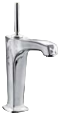
E16231-4 Monomando lavabo alto Vaciador manual tipo "Click" recubierto Caudal limitado 6 l/mn Altura 297 mm, Salida 162 mm.
