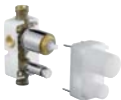
E882-NF Cuerpo empotrado baño-ducha (G ½) Asociado a todas las partes exteriores baño-ducha. Limitador de temperatura regulable. Caudal: 33 l/min.
