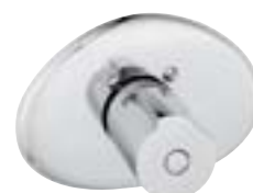
E71087 Termostato empotrado Cuerpo empotrado (G ½") y parte exterior con empuñadura de temperatura. Temperatura máxima a 50° C. A completar con una llave de paso.
