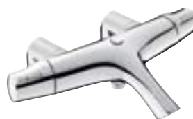
E71685 Termostato sobre playa baño-ducha Economizador de agua. Tope de seguridad a 40° C. Bloqueo de temperatura máxima a 50° C.
