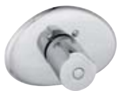
E75086 Llave de paso - inversor 2 posiciones, para empotrar. Baño-ducha o 2 salidas ducha. Cuerpo empotrado (G ½") y parte exterior con mando.
