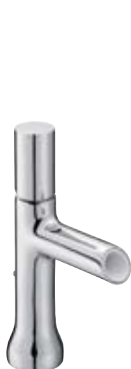
E8959 Monomando lavabo. Varilla lateral. Vaciador automático. Altura 202 mm. Caudal limitado a 8 l/mn.
