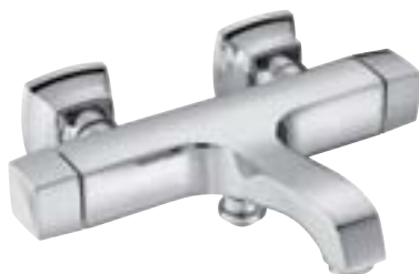
E16215-9 Termostato mural de baño- ducha. Inversor disimulado en la toma del flexo. Tope de seguridad a 38° C – Temperatura máxima a 50° C
