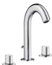
E10086-CP Bimando lavabo 3 agujeros Caño fijo. Vaciador automático. Altura 236 mm, Salida 138 mm.
