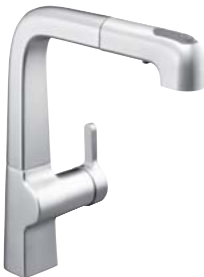
6331 Monomando de cocina. Caño alto orientable. Ducha extraíble y flexo con contrapeso de recuperación. Aireador 2 jets anti-calcáreo. Caudal limitador a 8 l/mn.
