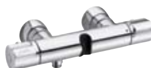
E71089 Termostato mural de ducha Economizador de agua. Tope de seguridad a 40° C. Bloqueo de temperatura máxima a 50° C. Soporte ducha integrado.
