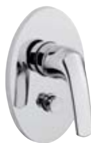
E18019-4 Monomando baño-ducha para empotrar. Parte exterior con inversor automático. E882-NF Cuerpo empotrado G 1/2". Caudal 33 l/mn.
