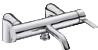
E12769-4 Monomando mural de baño-ducha sobre playa Inversor disimulado en la toma del flexo. Limitador de temperatura. Válvula anti-retorno en la salida de ducha. Aireador anti-calcáreo.
