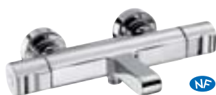
E10870 Termostato mural de baño-ducha. Tope de seguridad a 38°C. Tope máximo a 50° C. Inversor integrado en el mando del caudal.
