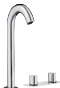
E10094-CP Bimando lavabo - alto. Caño fijo disociado de los mandos. Sin vaciador automático. Caudal regulado a 6 l/mn. Altura 350 mm, Salida 227 mm.
