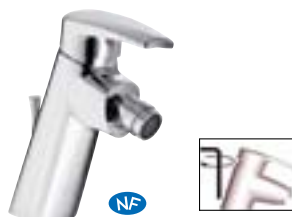
E73240 Monomando bidé. Vaciador automático. Aireador sobre rótula orientable. Fijación rápida por arriba.
