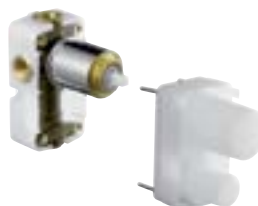
E880-NF Cuerpo empotrado ducha (G ½) Asociado a todas las partes exteriores ducha. Limitador de temperatura regulable. Caudal: 24 l/min.
