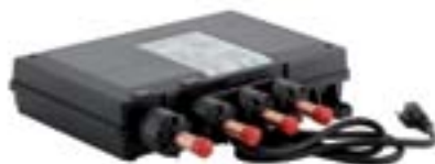
528K Válvula termostática digital. 2 entradas y 2 salidas de G ½". Suministrado con 6 metros de cable de conexión al Interface.
