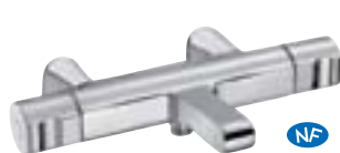
E10871 Termostato sobre playa de baño-ducha. Tope de seguridad a 38°C. Tope máximo a 50° C. Inversor integrado en el mando del caudal.
