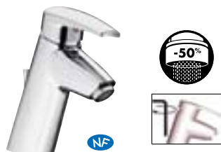
E72240 Monomando lavabo. Vaciador automático. Aireador anti-calcáreo. Fijación rápida por arriba. Altura 160 mm, Salida 102 mm.
