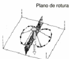
b) Hormigón fisurado
