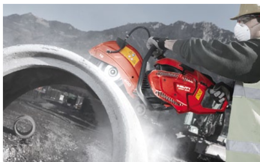
La DSH 900-40 hace más fácil el corte en tubos de hormigón con una profundidad hasta 150mm.
