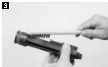
Exterior de la guía del pistón (9).
