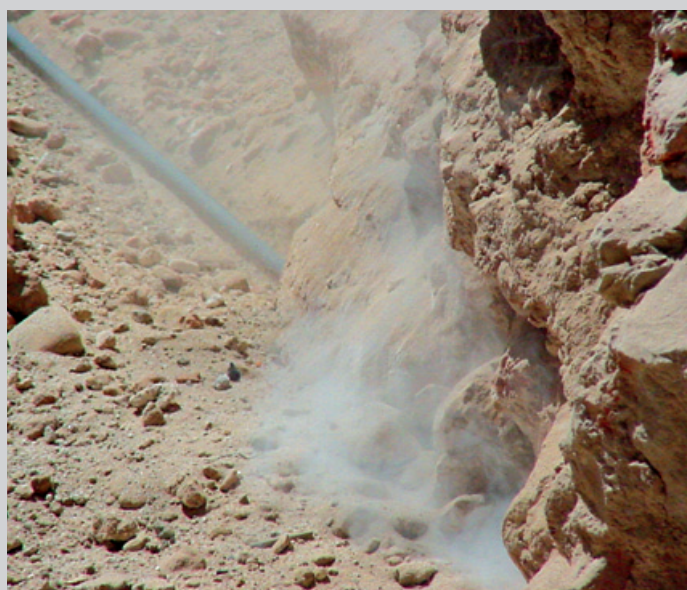
El hilo Hilti de corte en seco trabaja completamente sin agua.
