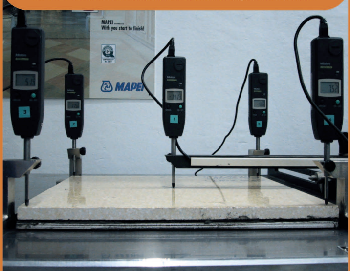
Foto 2 - Prueba de encolado sobre una capa de adhesivo
