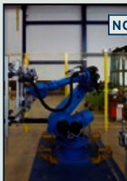
5. Pegado automático del cristal al marco
