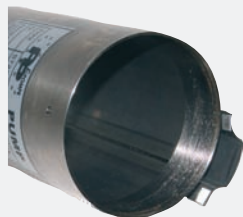
CAMISA EXTERIOR EN ACERO INOX 304 PULIDO DE GRUESO 1,5 mm CON ROSCA MILIMÉTRICA
