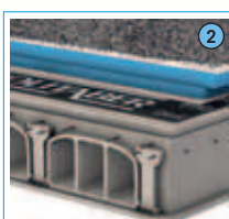
CUBIERTA NO TRANSITABLE ACABADO GRAVA
