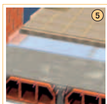
SUELO ANTIIMPACTO ESTÁNDAR Productos: ChovAIMPACT PLUS Aislamiento acústico: \Delta L_w=24 dB; L_{nw}=54 dB
