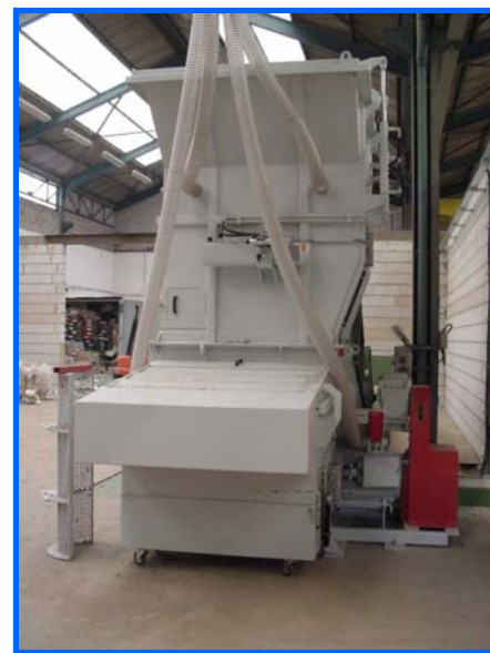
Tolva especial con tapa y aspiración neumática para el polvo
