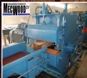
Multiples de 1 eje, Altura de corte 300 mm; 120 m/min
