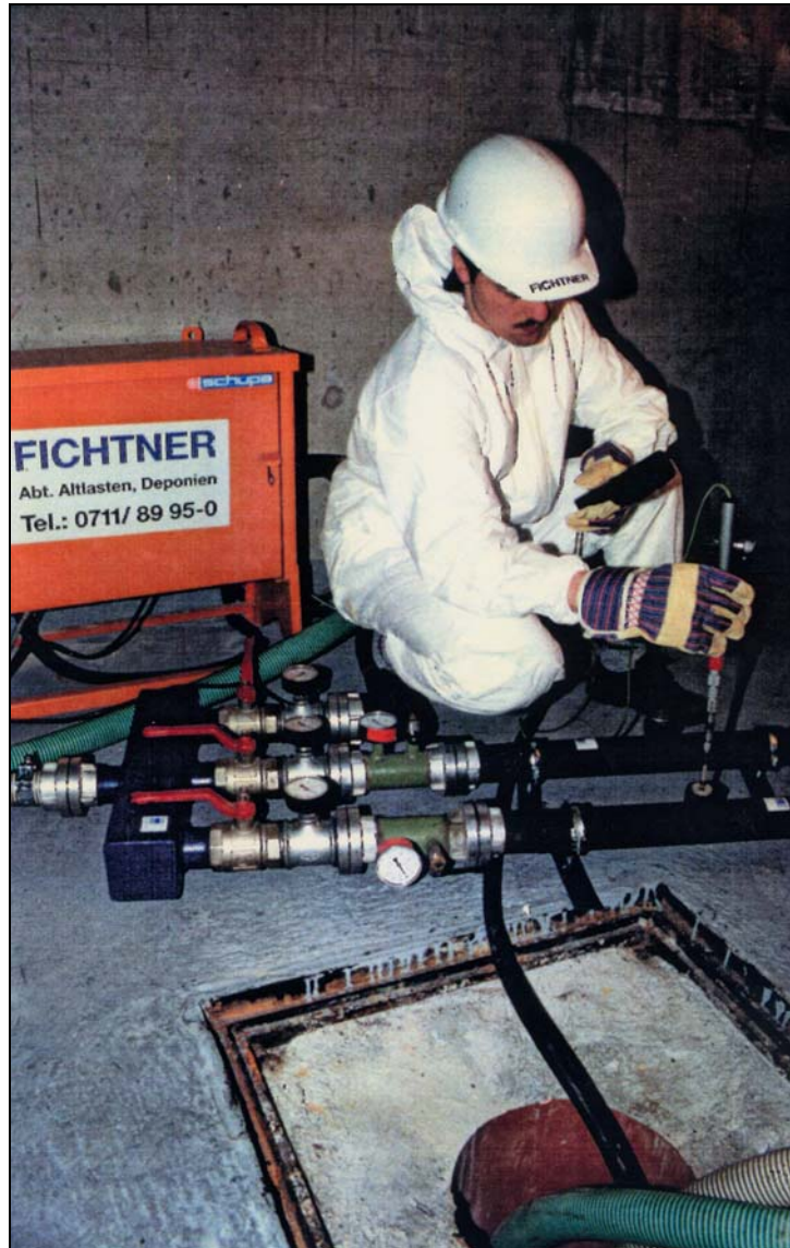
Fig. 7 Tomas de muestras de un lixiviado procedente de un vertedero conteniendo residuos tóxicos, en fase de recuperación
