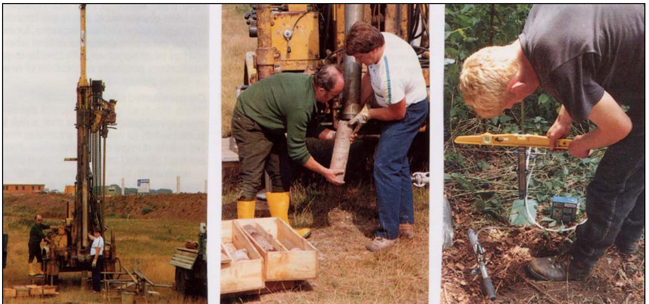
Fig. 2 Etapas de tomas de muestras de suelos (por estratos) y del aire contenido en un suelo
