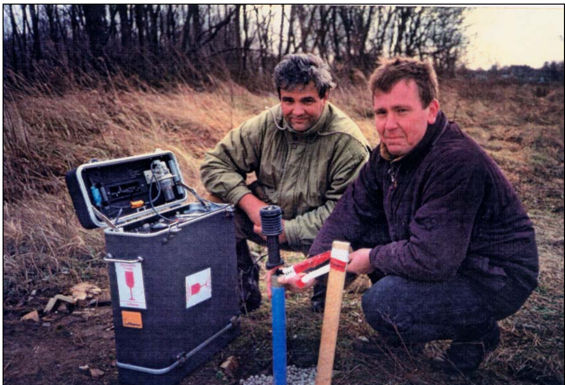
Fig. 3 Medición de gases procedentes de un vertedero abandonado y en fase de recuperación
