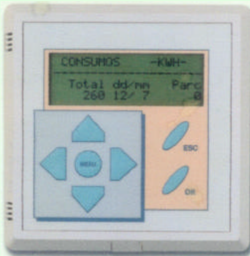
Fig 2. Panel de mandos de vivienda
