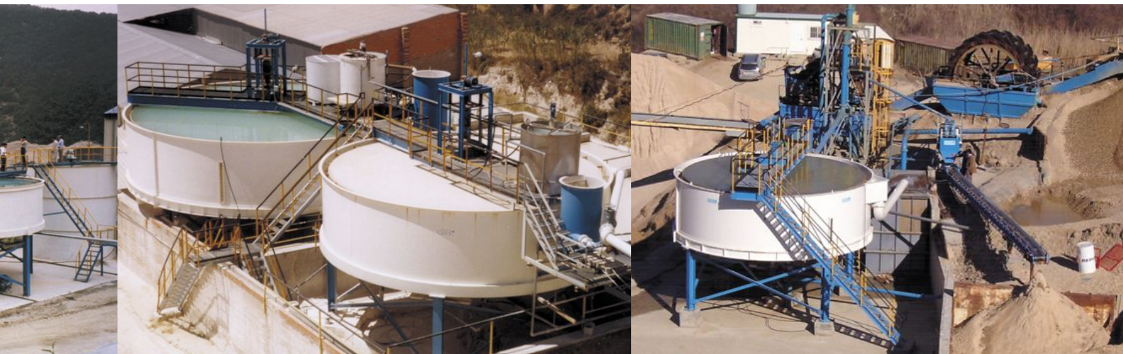
Espesado de caolín en tanques 10 m y 8 m Ø con sistema de elevación rastras
