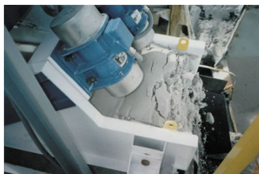
Escorrido de arenas de mortero
