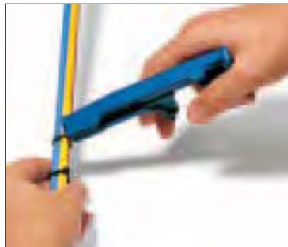
Corte, girando la herramienta.
