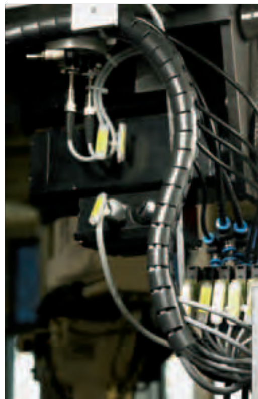
El mejor y más eficaz protector, ya que es posible bifurcar cables en cualquier punto a lo largo de su cuerpo.
