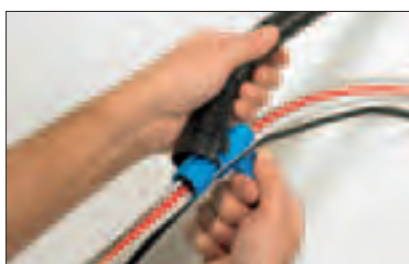
Coloque la herramienta en un extremo de la Helawrap.
