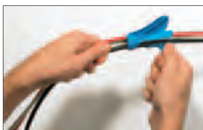
Introduzca uno o más cables en la abertura de la herramienta.
