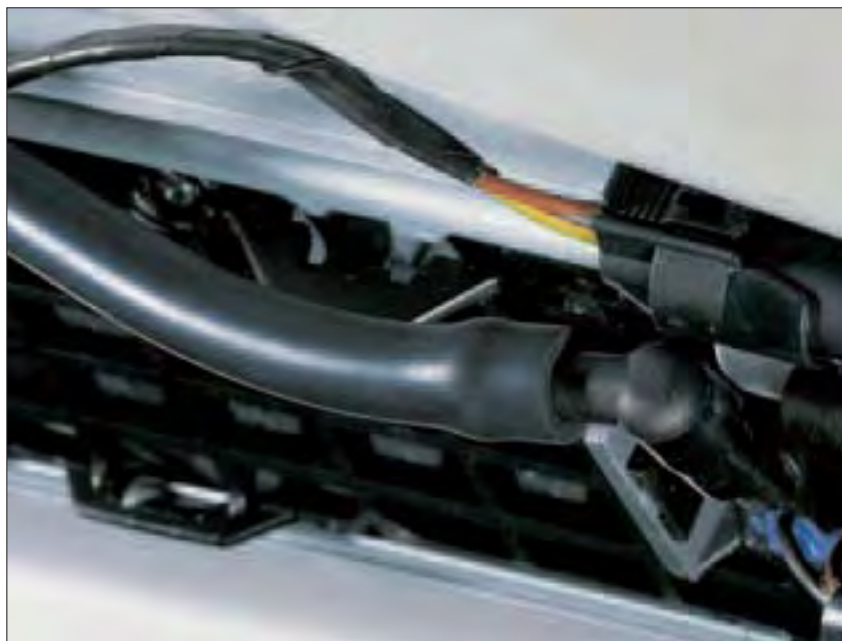
Tubo EPDM para sistemas de limpiaparabrisas en automóviles.
