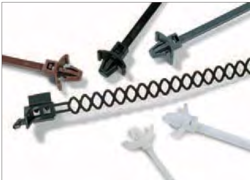
Amplia gama de Bridas con Fijación de Flecha, para espesores de chapa de 0,5mm a 4,5mm y taladros entre 4,4mm a 8,0mm.
