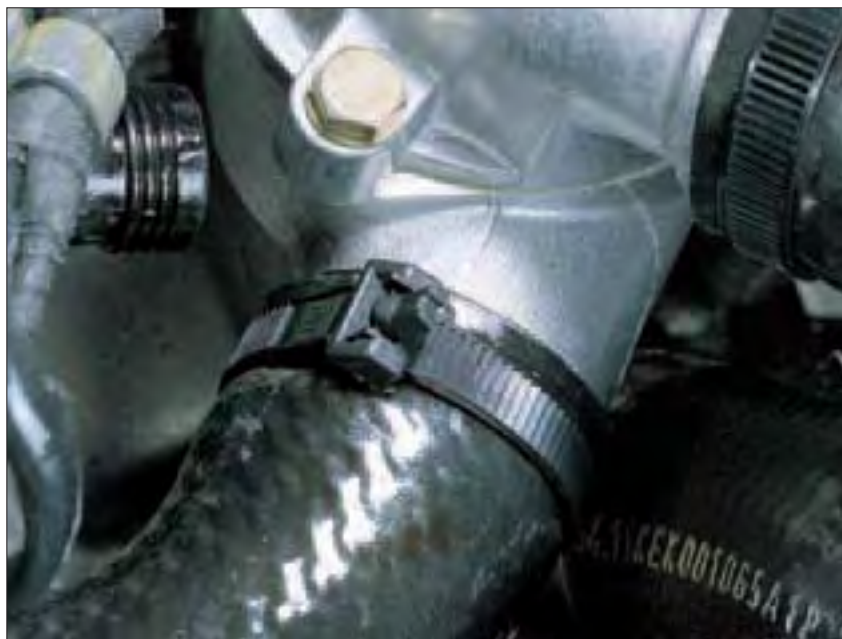
Brida RT250, usada en el compartimiento de motor de un coche, fijando un tubo.
