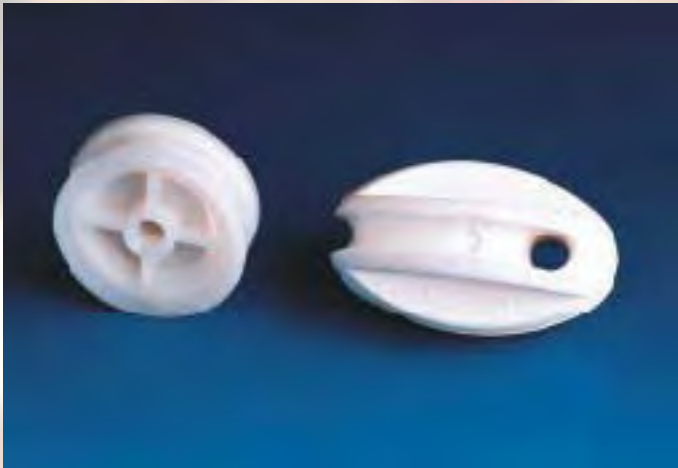
Aisladores. Polea y huevo 3000V., tracción 1000 Kg. Insulator. Wheel and egg 3000V, 1000kg traction.
