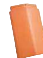
cumbrera especial para teja plana 404 x 258 mm. 2,93 kg. 224 uds./palet
