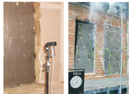
Puertas acústicas y clasificación al fuego con niveles de aislamiento superiores a los 40 dB.
