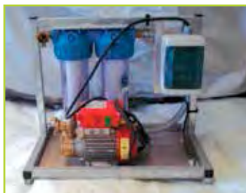
Sistema de filtración - SF
