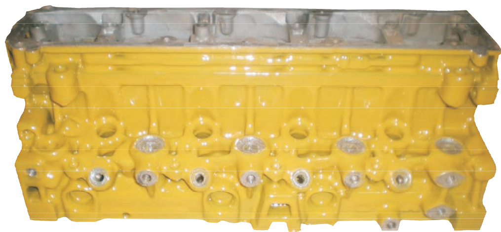
Revestimiento de culata en poliuretano
