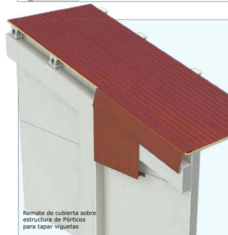
Apoyo de Jácena 1 lateral con Cerramiento horizontal exterior y vigueta V60
