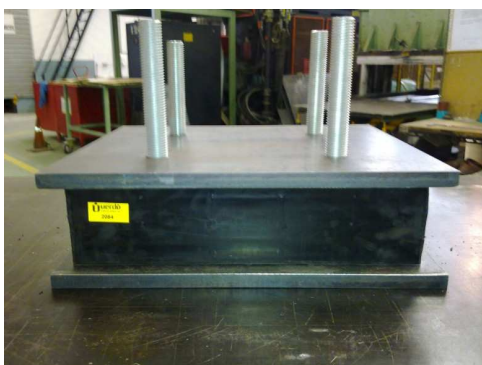
Apoyo elastomérico zunchado anclado superior e inferiormente con pernos roscados superiores y disco giratorio
