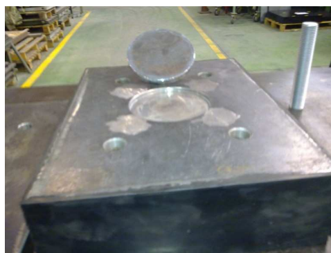
Apoyo elastomérico zunchado anclado superior e inferiormente con pernos roscados superiores y disco giratorio
