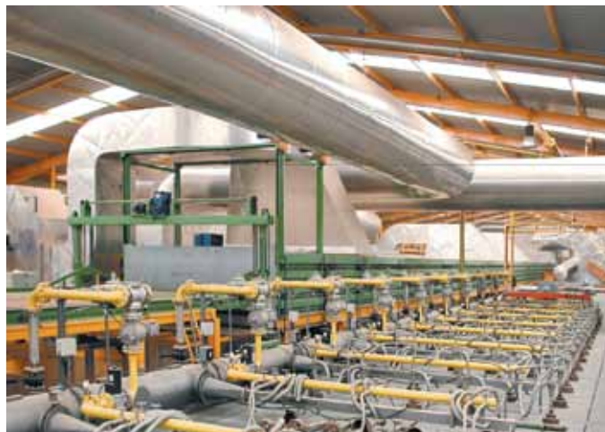
Quemadores de biogás en la planta de Piera Ecocerámica
