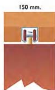
FIG. A Marco de 150 mm. con RIEL OCULTO sobre marco, y puerta totalmente enrasada.
