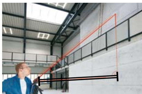
Medición indirecta de alturas con las funciones Pitágoras.
