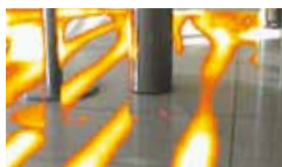
Imagen de fusión térmica de la inspección de un suelo radiante
