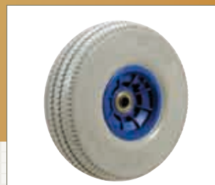
RIG Rueda neumática impinchable gris Neumático impinchable de 250 mm relleno de espuma. Núcleo de plástico azul con rodamiento de bolas.
