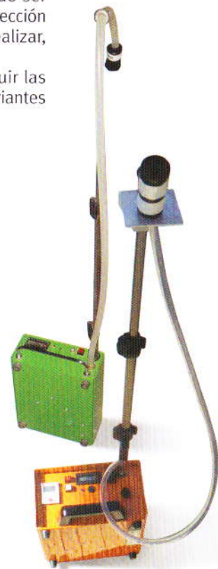
Medidores ambientales de amianto.
