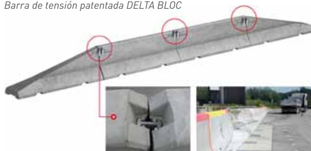
Cadena de elementos después de un impacto con un camión articulado de 38 Tn.
