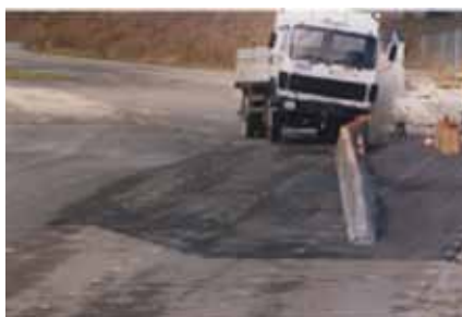
Vuelta a la calzada e impedimento de vuelco de un camión articulado de 38 t.
