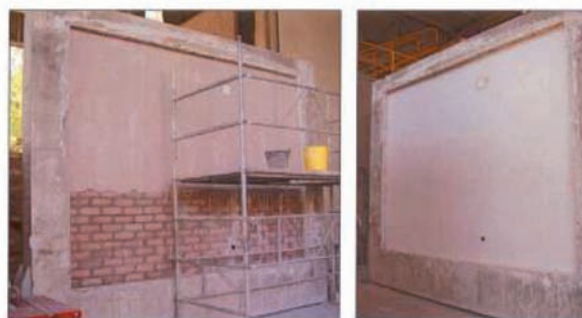
Fotografías 5 y 6 Enyesado de la partición construida en el marco portamuestras
